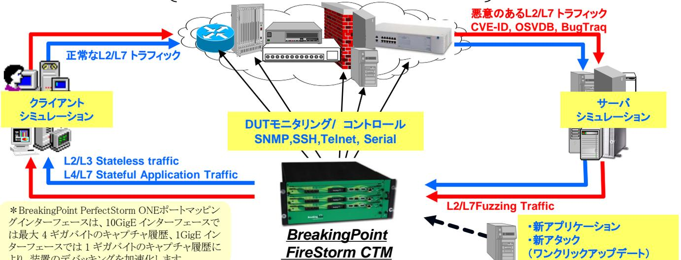
\* BreakingPoint PerfectStorm ONEポートマッピングインターフェースは、10GigE インターフェースでは最大 4 ギガバイトのキャプチャ履歴、1GigE インターフェースでは 1 ギガバイトのキャプチャ履歴により、装置のデバッグを加速化します。
